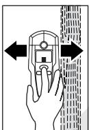
Déplacer alors l'appareil de mesure, la touche « **ZOOM** » **4** étant appuyée, de manière uniforme sur la surface sans soulever l'appareil et sans modifier la pression appliquée. Les glisseurs en feutre **8** doivent toujours être en contact avec la surface pendant l'opération de mesure.
