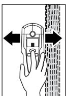
Merilno orodje s pritisnjeno tipko „**ZOOM**“ **4** enakomerno premikajte čez podlago, ne da bi ga dvignili ali spremenili moč pritiskanja. Med merjenjem morata biti polstena drsnička **8** v stalnem kontaktu s podlago.
