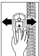
Beweeg het meetgereedschap, terwijl u de toets „**ZOOM**“ **4** ingedrukt houdt, gelijkmatig over de ondergrond zonder het gereedschap op te tillen of de aandrukkracht te veranderen. Tijdens de meting moeten de viltglijders **8** altijd contact met de ondergrond hebben.
