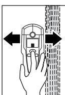
Pomicite mjerni alat sa pritisnutom tipkom „**ZOOM**“ **4** jednolično preko podlage, bez podizanja ili promjene pritiska. Tijekom mjerjenja klizač od filca **8** treba biti uvijek u kontaktu s podlogom.
