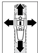
Postavite merni pribor na površinu koja treba da se ispita i pokrećite ga bočno. Ako se merni pribor približava nekom metalnom objektu, onda raste otklon u mernom pokazivanju **f**, a ako se udaljava od objekta, onda se smanjuje otklon. Na poziciji maksimalnog otklona nalazi se metalni objekt ispod sredine senzora (ispod označenog otvora **2**). Dokle god se merni pribor nalazi iznad metalnog objekta, svetli prsten **1** crveno, i čuje se trajan ton.
