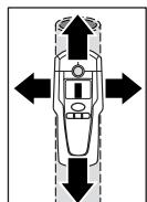
把探测仪放在探测表面上并左右移动仪器。当仪器渐渐靠近金属物体时，显示尺 **f** 上的显示刻度会逐渐上升。在仪器慢慢远离物体时，显示刻度又会慢慢下降。当显示刻度爬升到最高点时，代表金属物体正位在探测器的中央（即记号孔 **2**）的下方。如果不移动探测仪，光圈 **1** 会发出红灯并且仪器中会传出持续声响。
