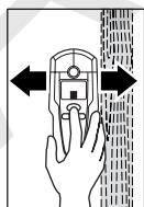
Равномерно перемещайте измерительный инструмент с нажатой клавишей «**ZOOM** 4 по всей площади, не отрывая его от поверхности и не изменяя усилия прижатия. Во время измерения фетровые подкладки **8** должны постоянно прилегать к поверхности.
