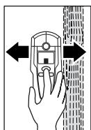
按住 "ZOOM" 按钮 4，并且均匀地在探测表面移动仪器，不可以提起仪器也不要改变施加在仪器上的力量。探测时绒毛滑垫 8 必须随时和探测表面保持接触。
