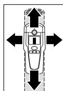
Placera mätverktyget på den yta som ska undersökas och förskjut det i sidled. När mätverktyget närmar sig metallobjektet ökar utslaget i mätvärdessapeln **f**, avlägsnas det från objektet minskar utslaget. Vid positionen med största utslaget befinner sig metallobjektet under sensorns mitt (under markeringsöppningen **2**). Så länge mätverktyget befinner sig över metallobjektet lyser ringen **1** med rött ljus och en permanent signal avges.
