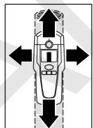
Tegye rá a mérőműszert a megvizsgálásra kerülő felületre, majd mozgassa el oldalra. Ha a mérőműszer közeledik egy fémtárgyhoz, az **f** mérőkijelző kijelzése növekszik, ha a mérőműszer távolodik egy fémtárgytól, a mérőkijelző kijelzése csökken. A legnagyobb kitérés esetén a fémtárgy az érzékelő közepe alatt (a **2** jelölőnyílás alatt) helyezkedik el. Amíg a mérőműszer a fémtárgy felett van, az **1** világító gyűrű piros színben világít és egy tartós hangjelzés hallható.
