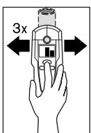
Για να εντοπίσετε το αντικείμενο με ακρίβεια πατήστε και κρατήστε πατημένο το πλήκτρο «**ZOOM**» 4, και στη συνέχεια μετακινήστε το εργαλείο μέτρησης επανειλημμένα (3 φορές) πάνω από το αντικείμενο. Στην οθόνη εμφανίζεται η ένδειξη λειτουργίας Zoom **d**. Η ένδειξη μέτρησης Zoom **é** έχει τη μεγαλύτερη απόκλιση πάνω από το κέντρο που μεταλλικού αντικειμένου **e**.
