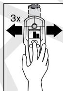
Drücken Sie für eine genaue Lokalisierung des Objektes die Taste „**ZOOM**“ **4** und halten Sie sie gedrückt, während Sie das Messwerkzeug wiederholt (3x) über das Objekt bewegen. Im Display erscheint die Anzeige der Zoom-Funktion **d**. Über der Mitte des Metallobjekts hat die Zoom-Messanzeige **e** den größten Ausschlag.
