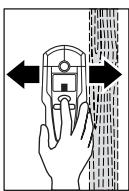
Movimentar o instrumento de medição uniformemente sobre o substrato, com a tecla “**ZOOM**” **4** premida, sem levantá-lo nem alterar a força de pressão. Durante a medição é necessário que o fio de deslize **8** tenha sempre contacto com o substrato.
