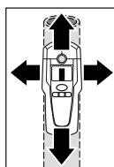
Sett måleverktøyet på overflaten som skal undersøkes og beveg det mot siden. Når måleverktøyet nærmer seg et metallobjekt, øker utslaget i måleanvisningen **f**, når det fjerner seg fra objektet, reduseres utslaget. I posisjonen med maksimalt utslag befinner metallobjektet seg under sensormidtpunktet (under markeringssåpningen **2**). Sålenge måleverktøyet befinner seg over metallobjektet, lyser ringen **1** rødt og det lyder et kontinuerlig lydsignal.
