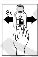
按下 "ZOOM" 按钮 **4** 能够更精确地显示隐藏物体的位置。先按住按钮，紧接着在发现物体的上方来回移动探测仪（3次）。此时显示屏上会出现放大功能的图案 **d**。当放大功能显示尺 **e** 的测量结果达到最高点时，则代表探测仪位在金属物体的正上方。
