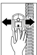
Turot nospiestu precīzas meklēšanas taustiņu „**ZOOM** **4**“, vienmērīgi pārvietojet mērinstrumentu pa seguma virsmu, to nepaceļot un nemainot spiedienu. Mērišanas laikā filca sīdvīrsmām **8** nepārtrauktī jāsaskaras ar seguma materiāla virsmu.
