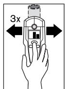
A fémtárgy helyzetének pontos meghatározásához nyomja meg és tartsa benyomva a „**ZOOM**” 4 billentyűt, és eközben ismét mozgassa el (3-szor) a mérőműszert a tárgy felett. A kijelzőn megjelenik a **d** Zoom-funkció kijelzése. A **e** Zoom-mérőkijelző kijelzése a fémtárgy közepe felett a legnagyobb.
