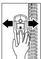
Pohybujte měřícím přístrojem se stlačeným tlačítkem „**ZOOM**“ **4** rovnoramě nad podkladem, bez nadzdvížení nebo změny přítlaku. Během měření musí mít plstěné kluzátko **8** vždy kontakt s podkladem.
