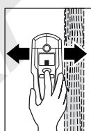
Urządzeniem pomiarowym z wcisniętym przyciskiem „**ZOOM**“ 4 poruszać równomiernie po podłożu, bez podnoszenia lub zmiany nacisku. Podczas pomiaru podkładki filcowe **8** muszą mieć zawsze kontakt z podłożem.
