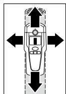
Nasadte měřící přístroj na prohledávaný povrch a pohybujete jím na stranu. Přiblížuje-li se měřící přístroj ke kovovému objektu, pak přibývá výchylka u ukazateli měření **f**, oddaluje-li se od objektu, pak výchylka ubývá. na místě maximální výchylky se nachází kovový objekt pod středem čidla (pod značkovacím otvorem **2**). Dokud se měřící přístroj nachází nad kovovým objektem, svítí kroužek **1** červeně a ozývá se trvalý tón.
