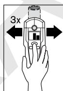
Per localizzare con precisione l'oggetto, premere il tasto «**ZOOM**» **4** e tenerlo premuto mentre si sposta ripetutamente (3 volte) lo strumento di misurazione sopra l'oggetto. Sul display appare la visualizzazione della funzione di zoom **d**. La visualizzazione di misura zoom **e** raggiunge il massimo delle oscillazioni quando si trova sopra il centro dell'oggetto metallico.
