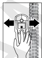
Пересуваєте вимірювальний прилад з натиснутою кнопкою «**ZOOM** 4 i» рівномірно по поверхні, не підіймаючи його і не змінюючи силу натискування. Під час вимірювання повстяні підкладки **8** завжди повинні мати контакт з поверхнею.
