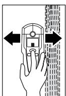
Bevæg måleværktøjet med nedtrykket taste „**ZOOM**“ **4** jævnth over undergrunden, uden at det løftes væk og uden at trykket ændres. Under målearbejdet skal filtglyderne **8** altid have kontakt med undergrunden.
