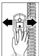
Benyomott „**ZOOM**” 4 billentyű mellett mozgassa egyenletesen a mérőműszert a felület felett, anélkül, hogy azt felemelné, vagy a rá gyakorolt nyomást megváltoztatná. A mérés közben a **8** nemez csúszkáknak állandóan érintkezésben kell lenniük a vizsgált felülettel.
