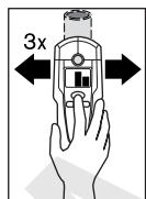
Paina koteen tarkkaa paikannusta varten painiketta "**ZOOM**" **4** ja pidä se painettuna, kun mittautstyökalu toistuvasti (3x) liikkuu koteen yli. Näytöön ilmestyy Zoom-toiminnon näyttö **d**. Metallikoteen keskipisteen kohdalla on Zoom-mittausnäyttö **e** suurimmillaan.
