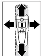
Aseta mittauslaite tutkittavaa pintaa vasten ja liikuta sitä sivuttain. Jos mittauslaite lähestyy metalliesinettä, mittausosoitus **f** kasvaa, esineen siirtyessä kauemmas osoitus pienenee. Metalliesine sijaitsee tunnistimen keskipisteen alla, osoituksen ollessa suurin (merkitäukon alla **2**). Mittauslaitteen ollessa metalliesineen päällä, rengas **1** loistaa punaisena ja yhtenäinen merkkiaani kuuluu.
