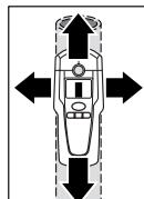
Anbring måleværktøjet på den overflade, der skal undersøges, og bevæg den ud til siden. Kommer måleværktøjet i nærheden af en metalgenstand, forstærkes udslaget i målevisningen **f**, fjernes den fra genstanden, forringes udslaget. Ved det max. udslag befinder metalgenstanden sig under sensormidten (under markeringsåbningen **2**). Så længe måleværktøjet befinder sig over metalgenstanden, lyser ringen **1** rød og der høres en konstant lyd.
