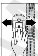
Mantenga pulsada la tecla “**ZOOM**” **4** y desplace uniformemente sobre el material de base el aparato de medida, sin separarlo y sin variar la presión de aplicación. Durante la medición deberán mantenerse siempre los fieltros de protección **8** en contacto con el material de base.
